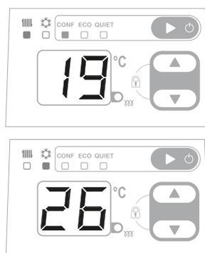
L'appareil affiche la température de confort. Lors de la première mise en marche, l'appareil est réglé à 19° C en fonctionnement Chauffage.
