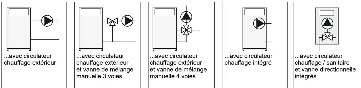
Ouvrir en grand la vanne de mélange manuelle dans le cas d'une chaudière chauffage seul.
