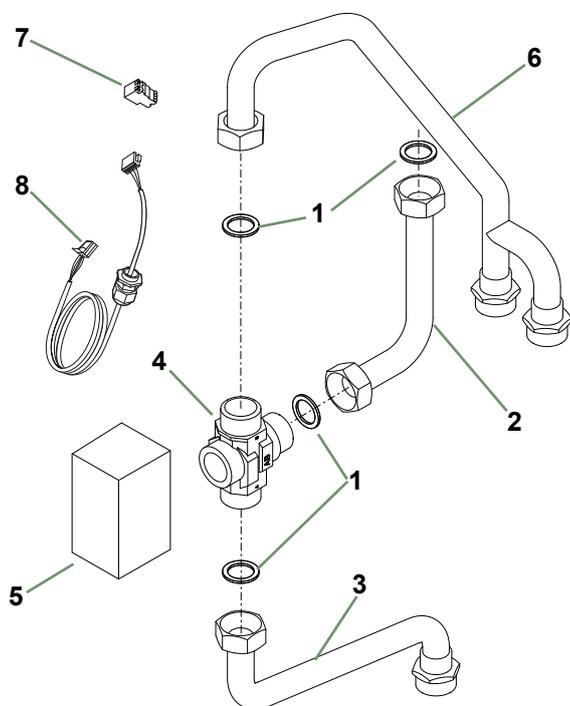
fig. 10 - Pièces détachées du kit relève chaudière
