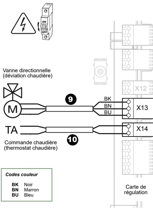
fig. 9 - Câblage électrique (kit relève chaudière)
